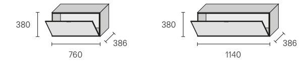
Modulo con anta a ribalta e schienale in vetro Module with flap door and glass back
